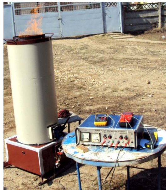
Fig. 2 Thermal module TLUD by 30 kW
