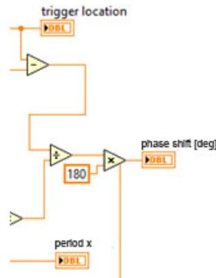
Fig. 7b Phase shift calculation
