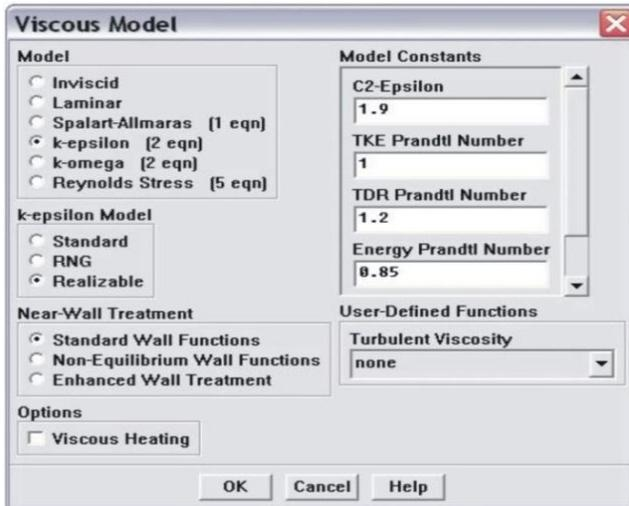
Fig. 7.  $k$ - $\varepsilon$  realizable turbulence model [5].
